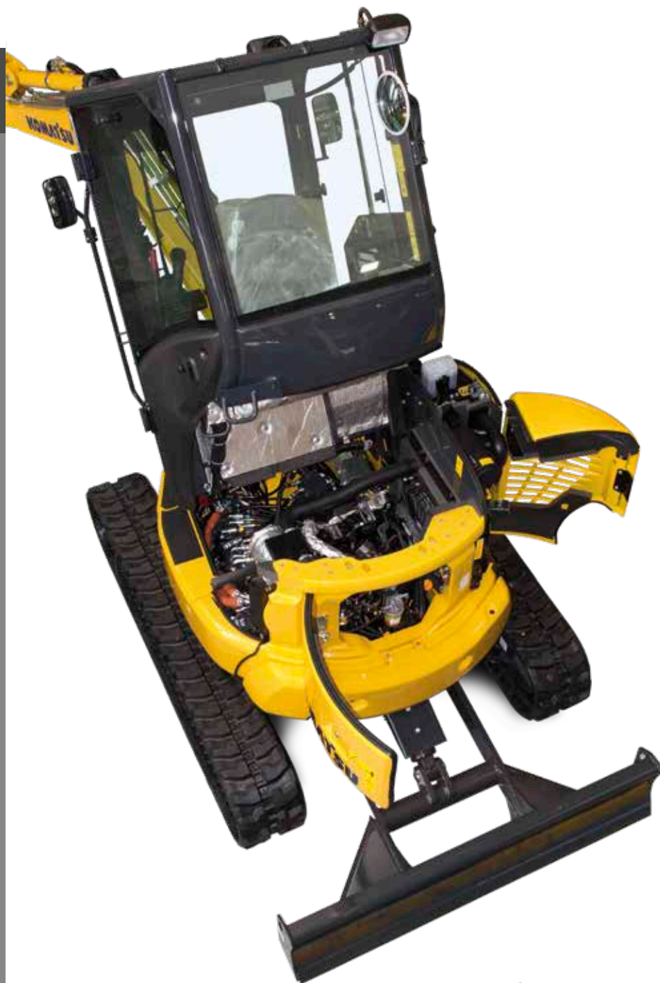
Cofani posteriori per controllo del motore, rifornimento carburante, ispezione e pulizia dei radiatori ed accesso alla batteria
